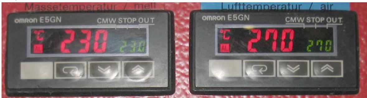
Рис.11 Установка температуры присадочного материала и горячего воздуха на экструдере с отдельными контроллерами
