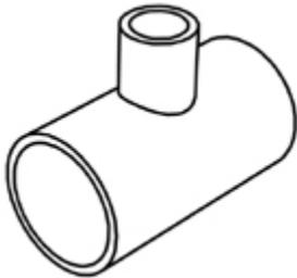
**Рис.11 Шов К-типа переменного сечения**
