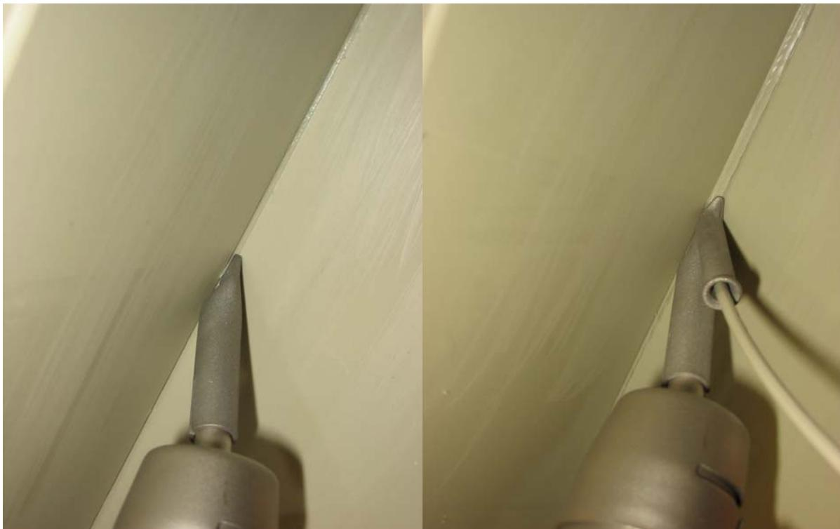
Рис.9 Фиксация листов перед сваркой шва К-типа
